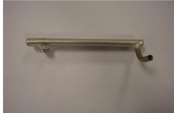
Pot d'échappement réalisé sur mesure
