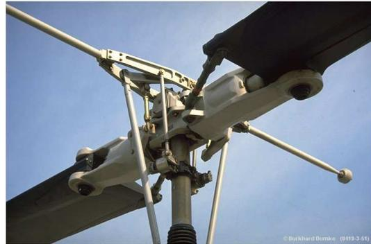
La barre Bell injecte de l'inertie dans la chaîne de commande
