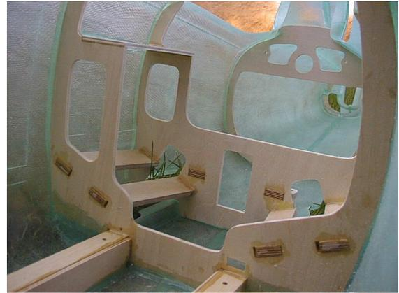
Les vitres, en plexiglas préformé, sont collées à la loctite sur le fuselage après tronçonnage au disque des emplacements. Il faut mastiquer le pourtour pour assurer la continuité avec le fuselage. Un assemblage par l'intérieur aurait évité cette finition fastidieuse et garanti un meilleur résultat.
