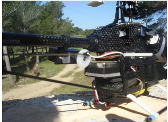
*La commande du rotor anticouple est fixée sur le palonnier du servo avec un déport de 4.5 mm. Le gyro est fixé sur l'étagère au dessus du récepteur*
