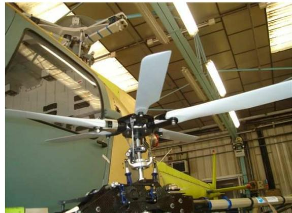
Le concept a aussi été expérimenté de façon satisfaisante sur un rotor tripale, les palettes sont positionnées avec un angle de 45° par rapport à l'axe de la pale. L'application sur un rotor multipales est possible selon le même principe.
