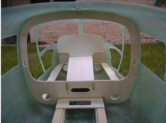
la tête rotor du moyeu pour retirer le carénage. Cette opération, déstabilisante pour les réglages, peut être évitée en découpant le carénage au niveau du mat rotor. Deux couples CTP (prévoir d'insérer une feuille de carton fin entre eux pour réserver l'épaisseur du disque à tronçonner), sont collés sur la paroi interne et 4 pions de centrage assurent la liaison.
