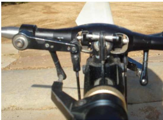
Levier de mixage de la commande directe du plateau cyclique et de la correction de la barre Bell-Hiller
