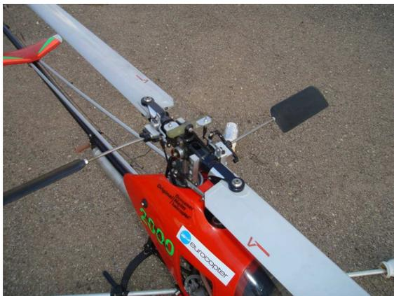
La pilotabilité satisfaisante de la maquette RC valide cette solution qui pourrait permettre sur un appareil grandeur de s'affranchir de l'assistance hydraulique car la palette se comporte comme un levier aérodynamique
