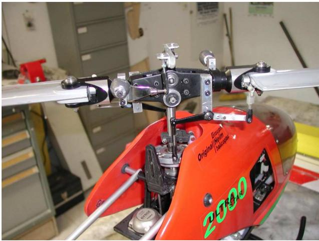
Des biellettes fixées sur le plateau cyclique actionnent le tube. Les essais ont démontrés une efficacité satisfaisante de la commande et permis un stationnaire contrôlé. Cependant un léger couplage en battement, dus à la position du tube en arrière de l'axe d'articulation, s'ajoute à l'ordre de commande. Plusieurs configurations du volet ont été essayées :
