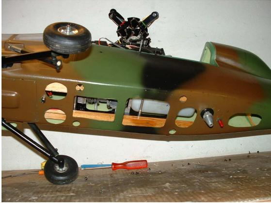
Trous d'aération sous le fuselage
