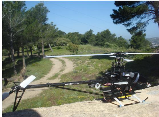
*L'architecture est similaire à celle de la famille Trex 450, à 600, flancs et poutre de queue carbone*
