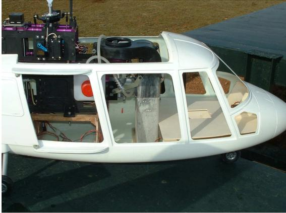
Le conduit de ventilation est prolongé jusqu'au fuselage
