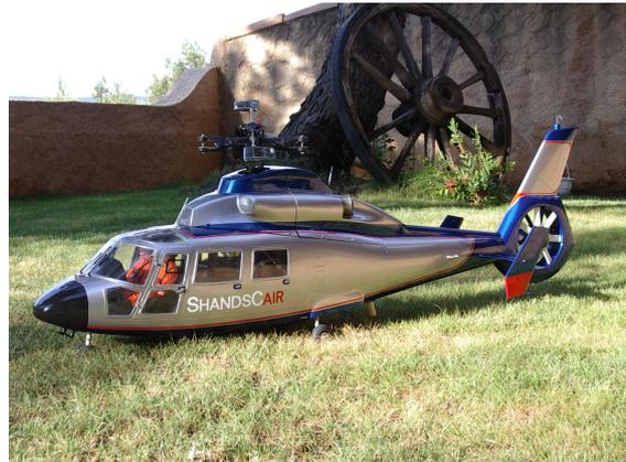
Dans le cockpit, les sièges, la planche de bord et sa visière sont fournis. Le plancher est peint en gris, la console centrale et la visière en noir. Les pilotes, manches cycliques et collectifs, palonniers, proviennent d'un kit Vario ainsi que les essuies glaces et antennes radio. Des housses de siège et des harnais de sécurité complètent l'équipement.
