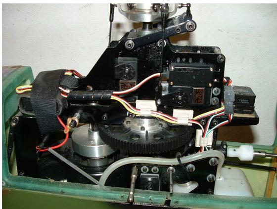
La première étape consiste à préparer le moteur: la bague conique, le ventilateur de refroidissement et la cloche d'embrayage sont assemblés sur l'arbre de sortie et maintenus par un écrou fermement serré.
