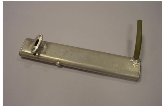
Il y a moins de 30mm disponible entre le plan de sortie moteur et la paroi interne du fuselage. Le pot d'échappement est donc très proche de cette paroi en composite. Afin de la protéger de l'échauffement, on collera sur la paroi intérieure du fuselage, au niveau du pot, une couche de matériau isolant (du type de celui employé pour faire les joints moteurs, par exemple la plaque OILIT, référence Graupner n° 796)
