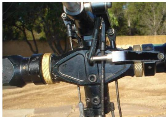
Tête rotor JR Sylphide sans correction delta, la rotule du levier de pas est alignée sur l'axe de rotation du balancier des pales.
