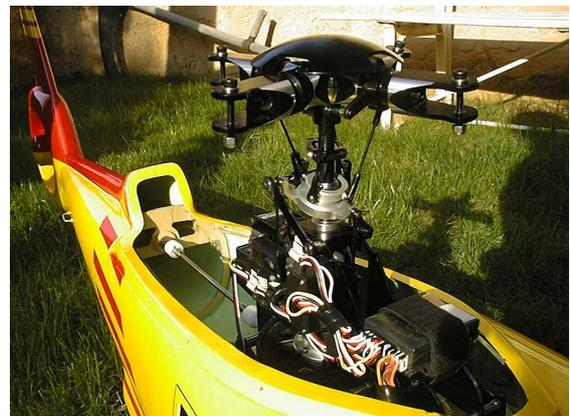
J'ai choisi un moteur OS 61SX HWC à culasse carrée, équipé d'un résonateur Yusa, pour entraîner l'étage de réduction. Le rapport de réduction ( #10 ) est obtenu par l'engrènement du pignon sortie moteur avec la roue principale.
