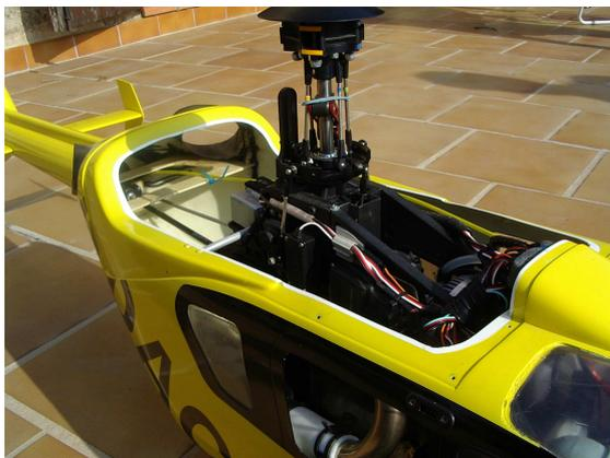
*Les capotages supérieurs déposés permettent un accès facile à la mécanique principale*
