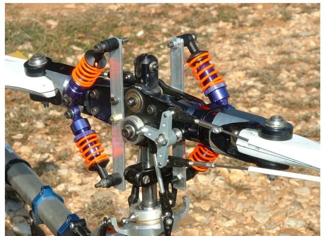
Essais de stabilisation de la pale en incidence avec des amortisseurs de voiture
