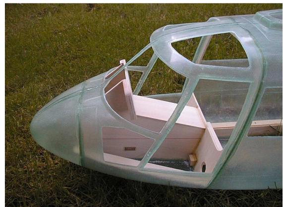
La vitre arrière droite n'a pas été montée afin d'améliorer le refroidissement cabine et de permettre l'accès au pointeau de réglage du carburateur.
