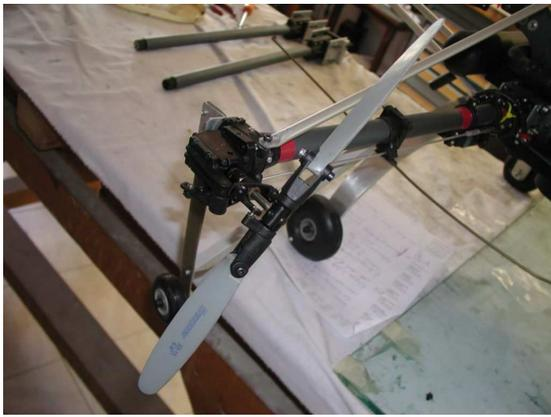
*Boîte de transmission et rotor arrière standard*
